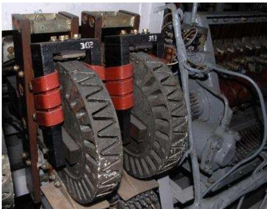
Рисунок 1 – Контактры БК-78Т на электровозе
