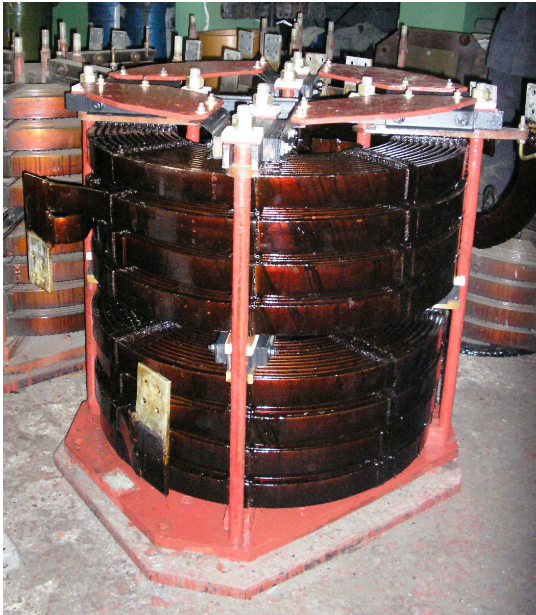
Рисунок 2 - Переходной реактор ПРА-48 (общий вид)
